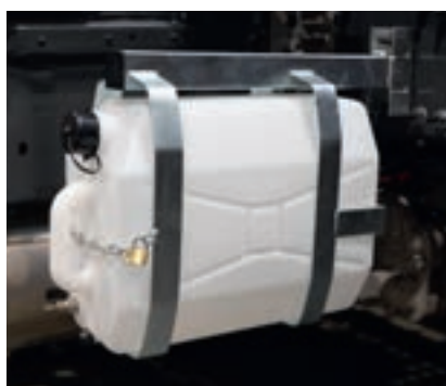
Depósito de água
